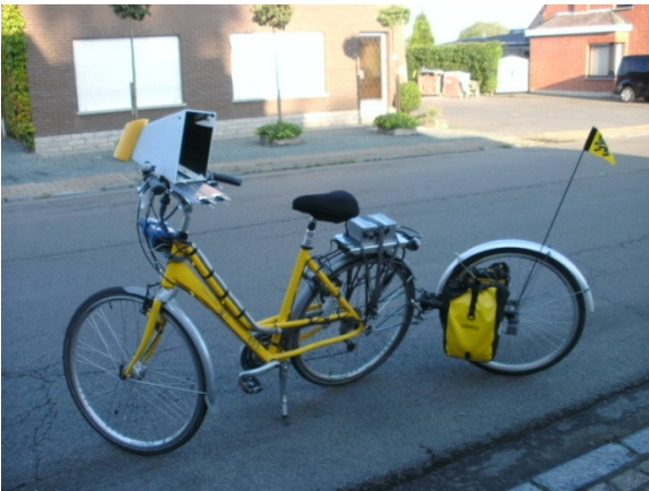
Foto 4.27 Meetfiets met stuurhut, extra-wheel, console, accelerator en batterij
